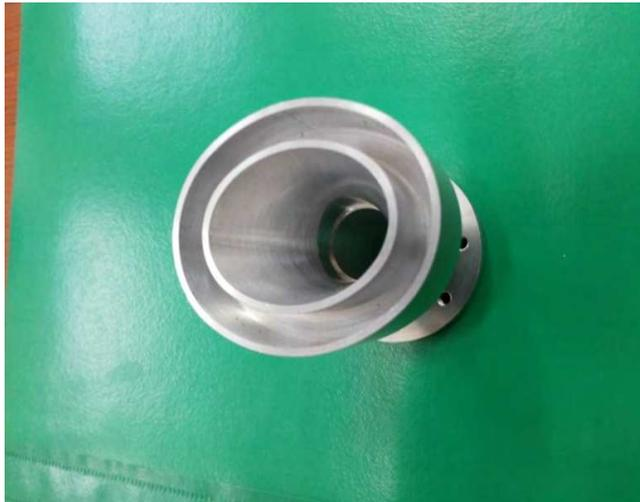
Fig. 2. Antenna feedhorn
